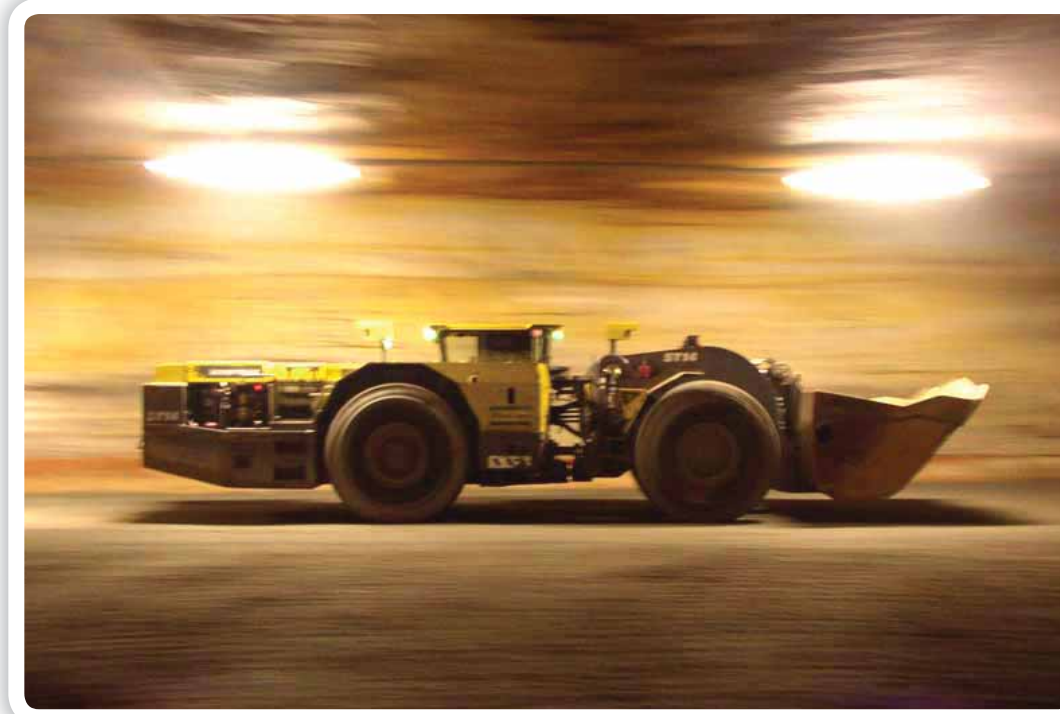
Autonomous Scooptram ST14 loader
